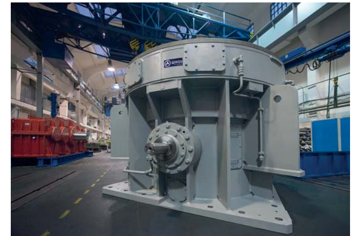
Převodovka vertikálního mlýnu po repasi a upgradu
